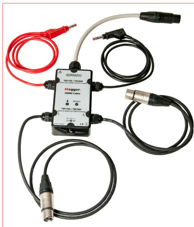
SDRM 电缆有三个版本；适用于 TM1800/1700、TM1600 和 EGIL。此图为 TM1800/1700 版本。
